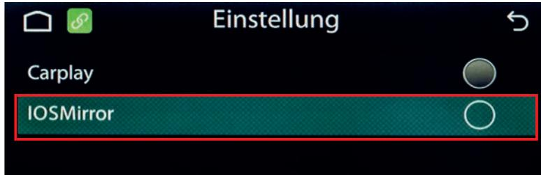
3. Nachdem Sie iOSMirror ausgewählt haben, schließen Sie das Apple-Datenkabel (Originalkabel, nicht im LDS-Lieferumfang) an das USB-Kabel des LDS-Interfaces an. Es wird ein Fenster „Diesem Computer vertrauen?“ angezeigt. Bestätigen dieses mit „Vertrauen“ und Airplay ist verbunden.
